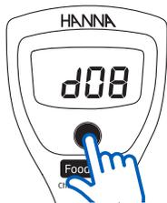
Desde el modo de medición, mantenga presionado el botón de Encendido/Apagado. La pantalla LCD mostrará "OFF", "CAL" y "d08" (configuración predeterminada: 8 minutos). Suelte el botón de Encendido/Apagado. Una sola pulsación del botón de Encendido/Apagado cambiará el temporizador de apagado automático a "d60" (60 minutos). Para desactivar el apagado automático, vuelva a presionar el botón de Encendido/Apagado; la pantalla LCD mostrará "d-". Mantenga presionado para salir.
