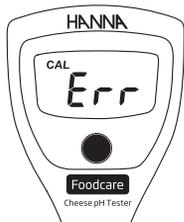
En el modo de calibración, si la sonda está en la solución estándar correcta y aparece el mensaje "Err", debe limpiarse. Sumerja la sonda en la solución de limpieza durante 20 minutos. Enjuague con agua e hidrate el electrodo en la solución de almacenamiento durante al menos 30 minutos antes de calibrar.
