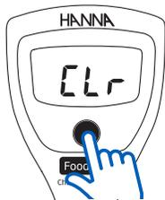
Para borrar la calibración del usuario y restaurar el tester a la configuración de fábrica, desde el modo de calibración, mantenga pulsado el botón de Encendido/Apagado. La pantalla LCD mostrará "CLr".
