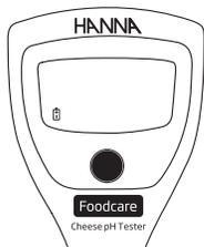
Cuando el nivel de batería sea bajo, la etiqueta en la pantalla LCD parpadeará. Cuando la batería esté agotada, aparecerá el mensaje "Err" y el tester se apagará.
