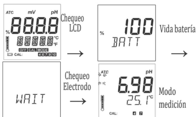
*Nota: El medidor detecta la presencia y el tipo de sonda en su entrada.*
