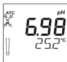
La pantalla LCD muestra el valor de pH (compensado automáticamente por temperatura) en la pantalla LCD principal, mientras que la pantalla LCD secundaria muestra la temperatura de la muestra. Si
