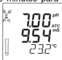
Enjuague bien el electrodo y sacuda el exceso de gotas. Vuelva a calibrar antes de usar. Sumerja la sonda en la muestra a analizar mientras la agita suavemente. Espere hasta que desaparezca la etiqueta ⌚ en la pantalla LCD.
