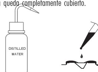
**Nota:** Si la muestra ZERO está sujeta a luz intensa, como luz solar u otra fuente de luz intensa, cubra la célula de medición con la mano u otro sistema para producir sombra durante la calibración.
