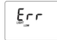
**Luz Baja:** No existe suficiente luz para realizar la medición. Por favor chequee la preparación de la cubeta cero.
