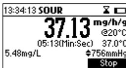
Si la lectura de OD es menor que el valor final de OD mínimo establecido durante la configuración SOUR, se mostrará un icono de advertencia y se escuchará un pitido cada dos segundos. Presione **Parar (Stop)** para detener la prueba y el beeper.
