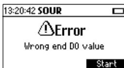
Presione **Iniciar (Start)** para comenzar una nueva prueba SOUR o **ESC** para volver a la pantalla de medición SOUR.
