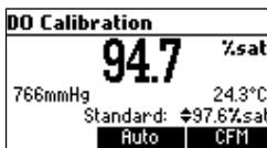
Presione CFM para confirmar el punto de calibración.
