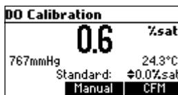
Presione CFM para confirmar el punto de calibración.
