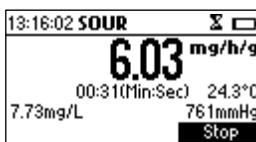
En caso de que el valor SOUR se corrija a 20 °C (68 °F) y la temperatura medida no esté en el rango de 10 a 30 °C, el valor de la temperatura parpadeará para alertar que la corrección de temperatura no es válida.
