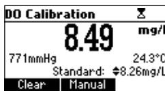
*El mensaje “Calibración borrada” se mostrará durante unos segundos y el medidor volverá a la pantalla principal. Si la función de presión manual está habilitada, la tecla Borrar estará activa solo durante 5 segundos después de acceder a la pantalla de calibración de OD, y luego será reemplazada por la tecla funcional Presión / Estándar.*
