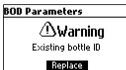
Si ya existe una botella con la misma ID, el instrumento solicitará la confirmación de reemplazo. Presione **Reemplazar** para reemplazar el registro existente, o **ESC** para regresar a la pantalla anterior sin reemplazar.
