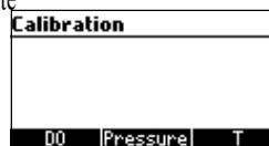
Se mostrará la pantalla de calibración de OD y se seleccionará automáticamente la saturación estándar del 0% (o 0 mg/L, dependiendo de la unidad de medición seleccionada actualmente).
