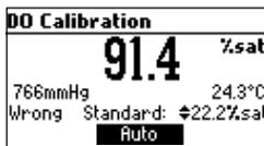
*Mientras está en el modo de calibración manual, es posible volver al modo de calibración automática presionando la tecla funcional AUTO. El medidor seleccionará el estándar más cercano a la lectura actual de OD.*
