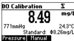
*Si se realizó una calibración previa, es posible borrar la calibración presionando la tecla funcional Borrar en la pantalla de calibración de OD.*
