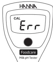
En el modo de calibración, si la sonda está en la solución estándar correcta y se muestra el mensaje "Err", se debe limpiar la sonda. Remoje la sonda en una solución de limpieza durante 20 minutos. Enjuague con agua e hidrate el electrodo en una solución de almacenamiento durante un mínimo de 30 minutos antes de calibrarlo.
