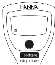
Cuando el nivel de la batería sea bajo, la etiqueta en la pantalla LCD parpadeará. Cuando la batería se agota, se muestra el mensaje "Erb" y el tester se apaga.
