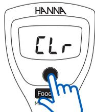
Para borrar la calibración del usuario y restaurar el tester a los valores predeterminados de fábrica. Desde el modo de calibración, presione y mantenga presionado el botón **ON/OFF**, la pantalla LCD mostrará "CL".
