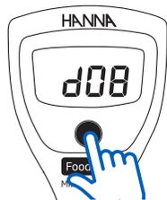
Desde el modo de medición, mantenga presionado el botón **ON/OFF**. La pantalla LCD mostrará "OFF", "CAL" seguido de "d08" (configuración predeterminada, 8 minutos). Suelte el botón **ENCENDIDO/APAGADO**. Una sola pulsación del botón **ON/OFF** cambiará el temporizador de apagado automático a "d60" (60 minutos). Para desactivar la función de apagado automático, presione el botón **ON/OFF** nuevamente, la pantalla LCD mostrará "d--". Mantenga presionado para salir.
