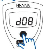
Mantenga pulsado el botón ON/OFF desde el modo de medición. El medidor pasará por el modo «OFF», «CAL» y después el apagado automático.
