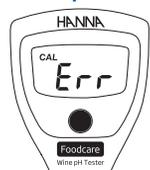
En el modo de calibración, si el medidor muestra un mensaje «Err» cuando está en la solución tampón nueva correcta, se debe limpiar la sonda. Meta la sonda en la solución de limpieza durante 20 minutos. Enjuéguela con agua destilada y póngala en la solución de almacenamiento durante al menos 30 minutos antes de la calibración.
