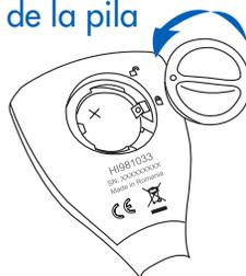
Para cambiar la pila de ión-litio CR2032, gire en sentido inverso a las agujas del reloj la tapa de la pila situada en la cara posterior del medidor para abrirla. Quite la tapa y sustituya la pila con el lado + hacia arriba.
