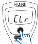
Entre en el modo de calibración. Mantenga pulsado ON/OFF hasta que se muestre «CLr». El medidor tendrá ahora la calibración por defecto.
