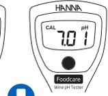
Cuando «7,01» parpadee en la pantalla, meta la punta de la sonda en una solución tampón de pH 7,01.
