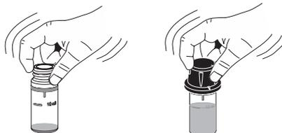
Para evitar fugas de reactivo y obtener mediciones más precisas, cierre la cubeta primero con el tapón de plástico HDPE
