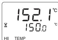
Se muestra "HI TEMP" si la temperatura del bloque del reactor está por encima del perfil de temperatura establecido en el programa.
