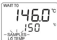
3. Presione la tecla **START** para iniciar la digestión programada. Una señal acústica (1 pitido corto) alerta al usuario de que la operación está en curso. El reactor de bloque se calienta hasta la temperatura configurada. El temporizador de cuenta atrás se inicia automáticamente.
