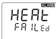
La etiqueta ALARMA y el mensaje "HEAT FAILED" se muestran si el bloque del reactor no se calienta 5 minutos después de presionar la tecla **START**. Una larga señal acústica alerta a los usuarios del problema.
