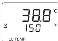
"LO TEMP" se muestra durante el proceso de calentamiento cuando la temperatura del bloque del reactor es inferior al perfil de temperatura establecido en el programa.
