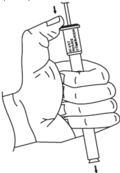
8. Apriete la tapa del electrodo en el cuerpo y llene el cuerpo del electrodo hasta que la solución de relleno llegue justo hasta la parte inferior del agujero de relleno.
