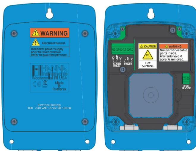
Utilice el destornillador Phillips y retire los cuatro tornillos, tire de la tapa hacia atrás y retírela.
