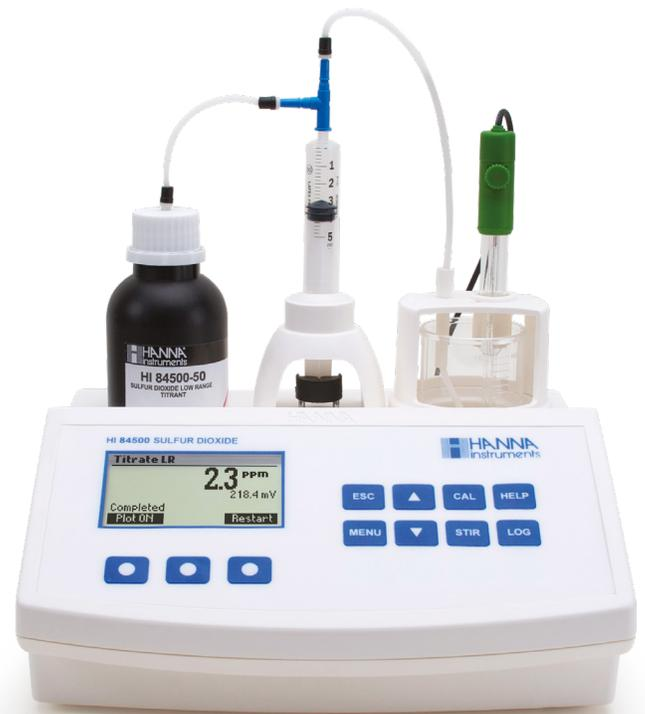
El HI84500 es un mini titulador automático, simple, rápido y asequible diseñado para probar los niveles de dióxido de azufre total o libre (SO<sub>2</sub>) en el vino. Basado en el Método Ripper, este mini titulador utiliza un método de análisis optimizado y preprogramado con un poderoso algoritmo que determina la finalización de la reacción de titulación mediante el uso de un electrodo de ORP especializado.
