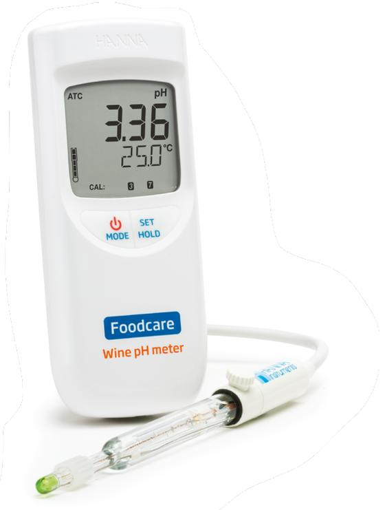
Diseñado para traer simplicidad a la medición de pH durante la producción de vinos, el HI 99111 permite lecturas rápidas y precisas de pH en muestras con un alto contenido de sólidos.
