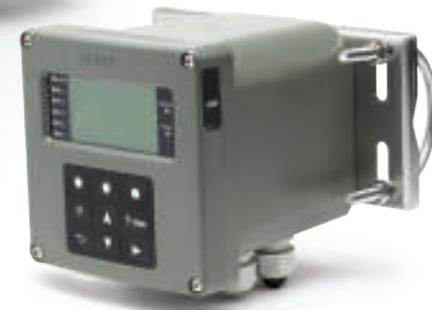
El controlador se puede montar en una tubería vertical u horizontal con el kit de montaje en tubería HI510-03. El kit incluye una placa de montaje recubierta de zinc, el hardware asociado y pernos en U para acomodar una tubería de 1", 1 ½" o 2".
