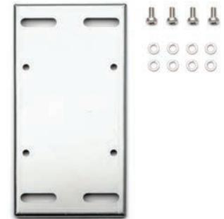
El controlador se puede montar en superficie con el kit de montaje en pared HI510-02. El kit incluye una placa de montaje recubierta de zinc y el hardware asociado. La placa puede estar orientada vertical u horizontalmente.
