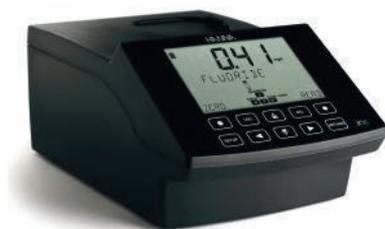
Elegante e intuitivo, el espectrofotómetro Iris permite realizar mediciones en todas las longitudes de luz visible gracias a su avanzado sistema óptico que reduce la luz parásita, compensa las desviaciones y no necesita tiempo de calentamiento. Cuenta con hasta 150 métodos de fábrica en los que se incluyen DQO, Nitrógeno y Fósforo Total, parámetros indispensables para la calidad de los vertimientos.
