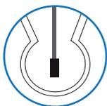
**¿Por qué?** La acumulación de residuos en el bulbo puede llevar a lecturas erradas y una vida útil más corta. Para esto no olvide utilizar la solución de limpieza ácida para grasa y manteca (HI70630L), y la solución de limpieza alcalina para grasa y manteca (HI70631L).
