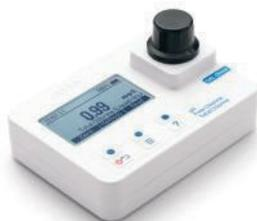
Los nuevos fotómetros HI97710 combinan la precisión con un uso simple, todo en un diseño portátil para permitir a cualquier usuario realizar mediciones profesionales de calidad de agua. Su sistema óptico innovador de bajo consumo, en conjunto con un modo tutorial, temporizadores incorporados y función CAL Check aseguran mediciones confiables y repetibles.
