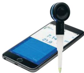
El electrodo FC2022 cuenta con un bulbo cónico en vidrio de baja temperatura que facilita insertarlo en muestras sólidas o semi-sólidas; diseño de unión abierta que resiste las obstrucciones y gel electrolítico que reduce la necesidad de mantenimiento. Además el FC2022 permite realizar mediciones profesionales a través de un Smartphone o Tablet, gracias a la aplicación Hanna Lab.
