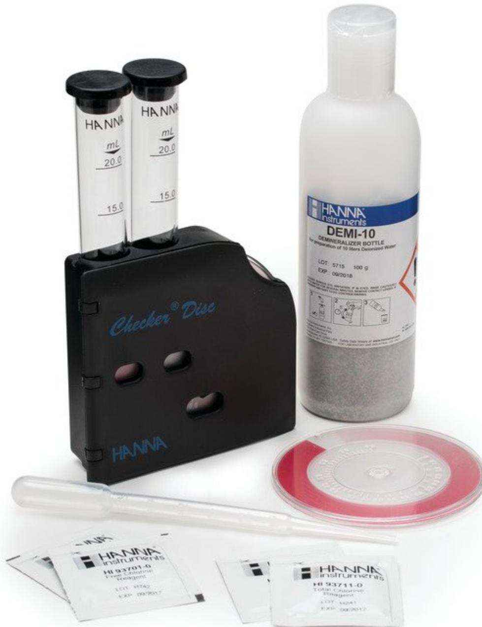
Los kits de prueba de titulación son fáciles de usar sin pérdida de resolución y precisión. Para determinar la concentración del parámetro químico, estos kits utilizan una técnica de titulación para contar el número de gotas de titulante necesarias para provocar un cambio de color en la muestra. Los frascos cuenta gotas hacen que la titulación sea extremadamente rápida y sencilla sin comprometer la precisión. El punto final se puede determinar con mayor precisión y simplicidad.
