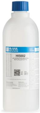
Solución de Calibración Técnica pH 2.00 (500 mL) – HI5002
