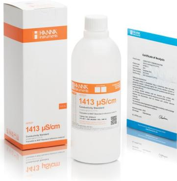
Solución de Calibración de Conductividad 1413 µS/cm (500mL) – HI7031L/C
