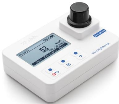
Fotómetro portátil de sílice de alto rango solamente – HI97770
