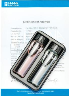
Set de Verificación de Calibración de Fósforo Rango Ultra Bajo para Checker® HC – HI736-11
