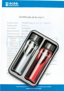
Set de Verificación de Calibración de Cloro Total para Checker® HC – HI711-11
