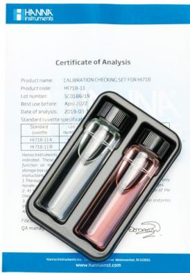
Set de Verificación de Calibración para Checker® HC de Yodo – HI718-11
