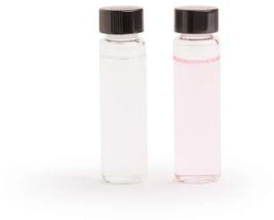
Set de Verificación de Calibración para Checker® HC de Fosfato Rango Ultra Bajo – HI774-11
