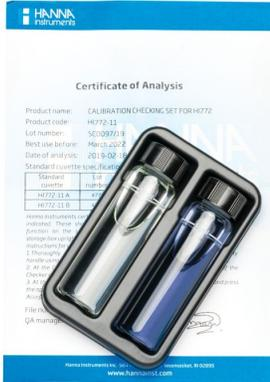
Set de Verificación de Calibración para Checker® HC de Alcalinidad Marina (dKH) – HI772-11
