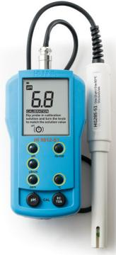
Medidor Portátil de pH/CE/TDS/Temperatura – HI9812-51
