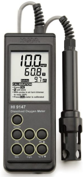
Medidor Portátil Galvánico de Oxígeno Disuelto – HI9147 con cable de 10m (32.8?)
