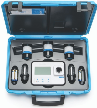
Fotómetro Portátil de pH, Cloro Libre y Total, Dureza Total y Hierro de Rango Bajo con CAL Check y Maleta – HI97745
