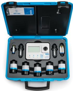
Fotómetro de pH, Alcalinidad, Cloro Libre, Cloro Total y Ácido Cianúrico y Maleta – HI97104
