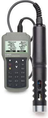
Medidor Impermeable Multiparámetro de pH/ORP/EC/TDS/Salinidad/DO/Presión/Temperatura – HI98194 con cable de 40m (131.2?)
