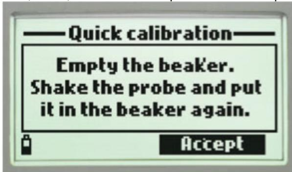
**Calibración rápida** La función de calibración rápida permite una calibración de un solo punto para pH, conductividad y oxígeno disuelto, todo en unos sencillos pasos.
