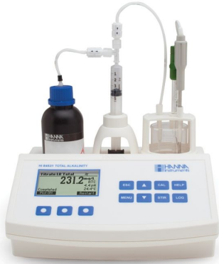
Mini Titulador para Medir la Alcalinidad Titulable en Agua Potable y Aguas Residuales – HI84531
