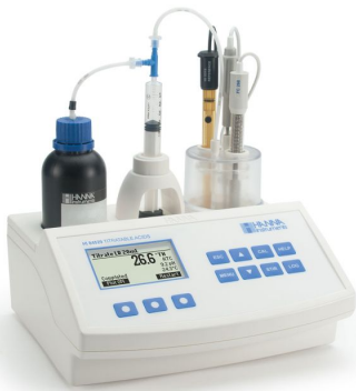
Mini Titulador para Medir la Acidez Titulable en Productos Lácteos – HI84529
