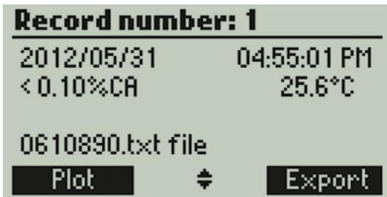
**Inicio de sesión bajo demanda** El HI84532 permite el registro de datos de hasta 400 muestras: 200 resultados de titulación y 200 lecturas de pH/mV. Los datos se pueden almacenar y exportar a una unidad USB o a una PC mediante la conexión USB.
