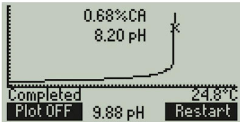
**Modo gráfico** Este mini valorador muestra datos detallados durante la valoración, incluido un gráfico en tiempo real de la curva de valoración.
