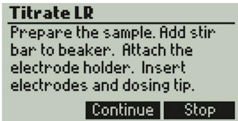
**Interfaz fácil de usar** El HI84532 tiene un diseño de usuario intuitivo con teclas claramente definidas y una pantalla grande que es fácil de navegar. El medidor tiene un modo tutorial incorporado que, cuando está habilitado, guiará al usuario paso a paso a través del proceso de titulación. Siempre hay disponible una tecla de AYUDA dedicada para permitir el acceso a información específica del contenido durante la calibración y la titulación.
