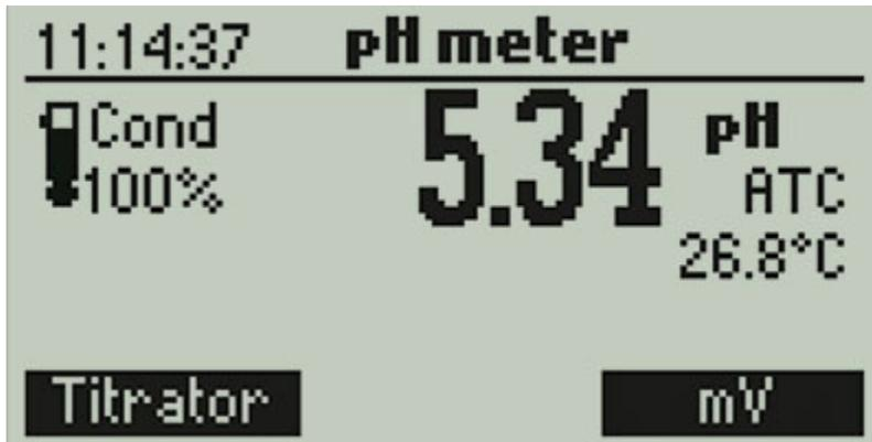
**Medidor de pH/mV** Además de ser un titulador automático, el HI84532 también se puede utilizar como medidor de pH/mV. Como medidor de pH, tiene muchas características de un medidor de mesa de calidad profesional, incluida la calibración automática de hasta tres puntos con cuatro tampones disponibles, una resolución de pH de 0,01, una precisión de pH de  $\pm 0,01$ , compensación automática de temperatura y datos GLP completos.
