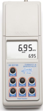
Medidor Portátil de Turbidez y Bentonita – HI83749
