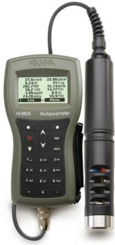
Medidor Multiparámetro Impermeable HI9829 de pH/ISE/EC/DO/Turbidez con opción de GPS – Sonda de registro con turbidez – 4m (13?)
