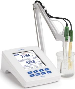
Medidor de Laboratorio de Grado de Investigación para pH/mV/ISE y CE/TDS/Salinidad/Resistividad HI5522
