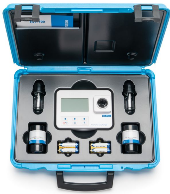
Fotómetro portátil de hierro de bajo rango – HI 97746C
