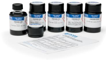
HI83308-11 Kit de Cubeta CAL Check para Fotómetro de Acondicionamiento de Agua HI83308
