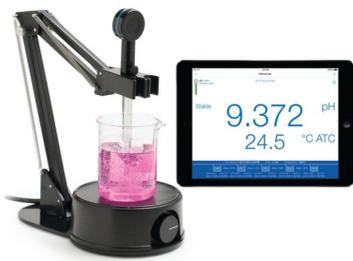
Electrodo de pH Recargable Bluetooth® HALO® con Punta Cónica para Alimentos – HI10532
