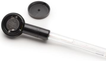
Electrodo de pH HALO con Cuerpo de Vidrio Relleno de Gel y Bluetooth – HI11102
