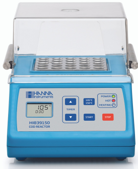
Calentador para Tubos de Ensayo DQO – HI839150
