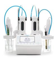
Titulador Potenciométrico Automático - HI932 con dos tarjetas de entrada para sondas potenciométricas
