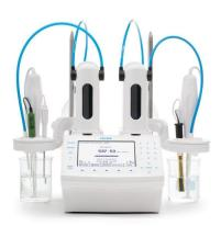
Titulador Potenciométrico Automático - HI932 con una tarjeta de entrada para sonda potenciométrica
