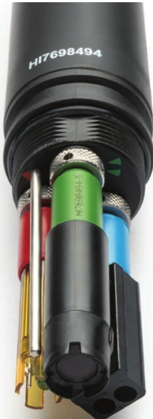
El reemplazo del sensor es rápido y fácil con conectores tipo tornillo reemplazables en campo y están codificados por colores para una fácil identificación.
