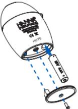
3. Retire la batería usada y sustítúyala por una nueva AAA de 1,5 V, insertando primero el extremo negativo.
