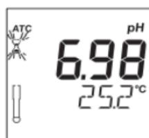
La pantalla LCD muestra el valor de pH (compensado automáticamente por temperatura) en la pantalla LCD principal, mientras que la pantalla LCD
