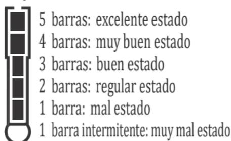
Con 1 barra se recomienda limpiar el electrodo y recalibrar. Si todavía hay solo 1 barra o 1 barra parpadeando, reemplace la sonda.
