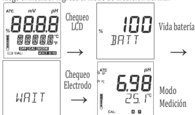
*Nota: El medidor detecta la presencia y el tipo de sonda en su entrada.*
