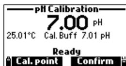
12. Después de confirmar el punto de calibración, y para evitar contaminación cruzada, sumerja los sensores en la siguiente solución tampón de enjuagado y remueva con suavidad.
