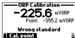
Si el valor de potencial redox introducido no está dentro del rango aceptable, se muestra «Wrong standard».
