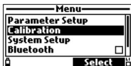
Todos los datos de calibración se almacenan en la memoria no volátil de la sonda, lo que permite conectar las sondas a distintos medidores sin necesidad de volver a calibrarlas.
