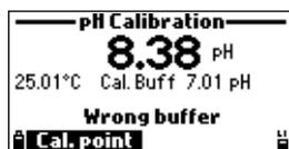
Se muestra «Wrong buffer» si la lectura de pH mostrada está demasiado alejada del valor del tampón seleccionado. Con frecuencia, esto se aprecia inmediatamente después de completar la calibración del tampón, pero antes de desplazar el sensor de pH al siguiente tampón. Compruebe si ha elegido el tampón de calibración correcto.
