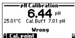
Se muestra «Wrong» si la pendiente de la calibración es errónea. Si la diferencia de pendiente entre la calibración actual y la anterior supera el intervalo de pendiente (80 % a 110 %).
