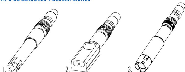
1. El sensor combinado de pH HI7698194-0 incorpora un sensor de pH con cuerpo de plástico con una membrana de vidrio y una referencia de plata/cloruro de plata con unión doble con solución electrolítica en gel.
