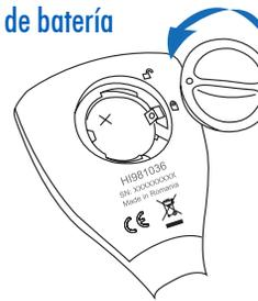
Para cambiar la batería de ion de litio CR2032, gire la cubierta de la batería ubicado en la parte posterior del medidor en sentido antihorario. Retire la tapa y vuelva a colocar la batería con el lado + hacia arriba.
