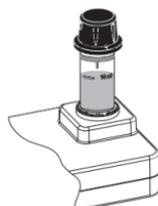
• Coloque la cubeta en el soporte y verifique la alineación de la muestra.
