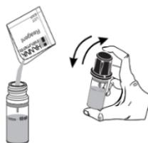
• Presione la tecla **Leer** y la pantalla mostrará la cuenta regresiva de 1 minuto antes de la medición. Después de 1 minuto, invierta la cubeta 5 veces. Vuelva a insertar la cubeta en el soporte y compruebe la alineación de la muesca. Para omitir el temporizador, presione **Leer** dos veces.
