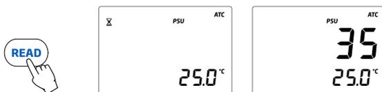
**Nota:** El último valor de medición se mostrará hasta que se mida la siguiente muestra o se apague el instrumento. La temperatura se actualizará continuamente.
