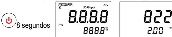
2. Mientras mantiene presionada la tecla **ON/OFF**, presione la tecla **ZERO**. La unidad de temperatura cambiará de °C a °F o viceversa.
